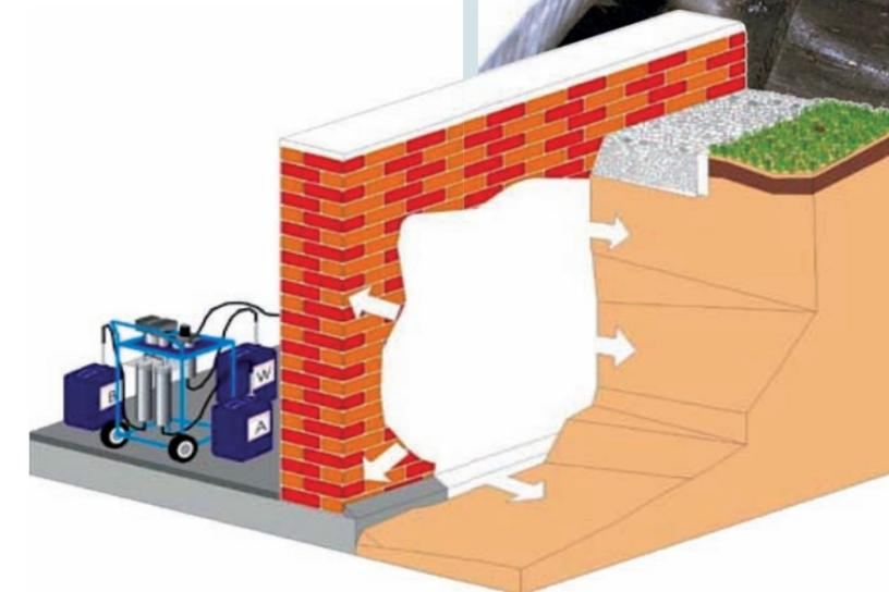
Interventi dall'interno del fabbricato o struttura, per realizzare una impermeabilizzazione di cortina all'esterno della muratura controterra o della platea, di tipo esteso, continuo ed elastico
